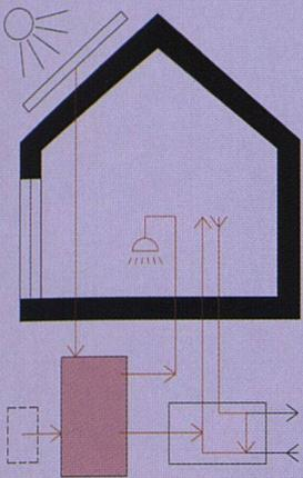
**Lüftung:** Eine sehr gute Wärmedämmung und eine mechanische Lüftung sind Grundvoraussetzungen für ein ökologisches Haus. Der Vorteil einer mechanischen Lüftungsanlage ist neben der Vermeidung von Wärmeverlusten, die durch das manuelle Lüften entstehen, die Möglichkeit der Wärmerückgewinnung. Dabei wird der verbrauchten Raumluft, die ins Freie geleitet wird, die Wärme entzogen und der Frischluft zugeführt.
