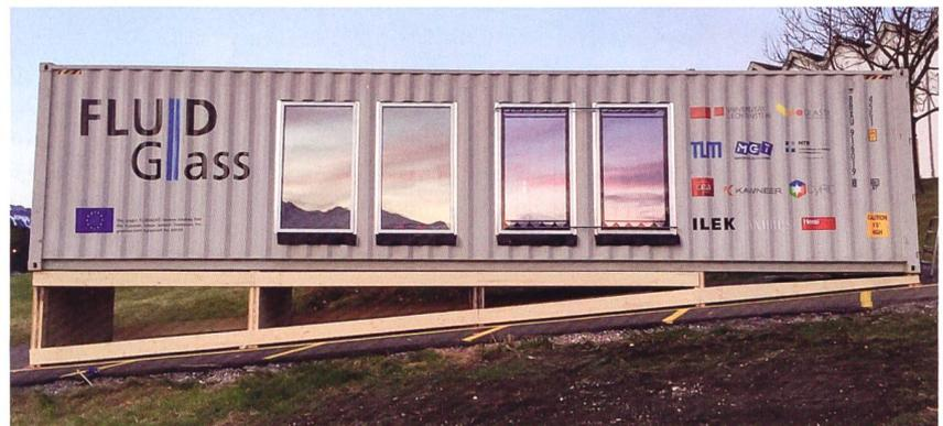
**Testcontainer mit Fluidglas. Bei diesem Fenstersystem wird Wasser als flüssiger Speicher eingesetzt; es kann aktiv heizen und kühlen.**
