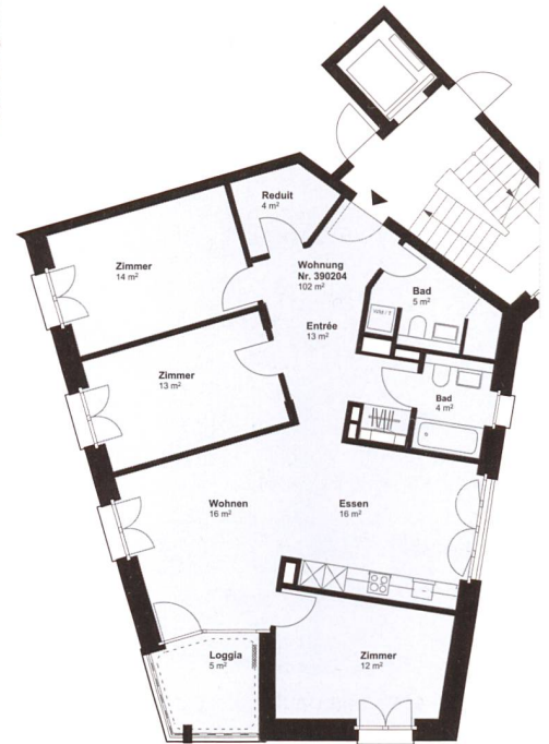
Grundriss einer Viereinhalbzimmerwohnung mit 102 Quadratmetern Wohnfläche.
