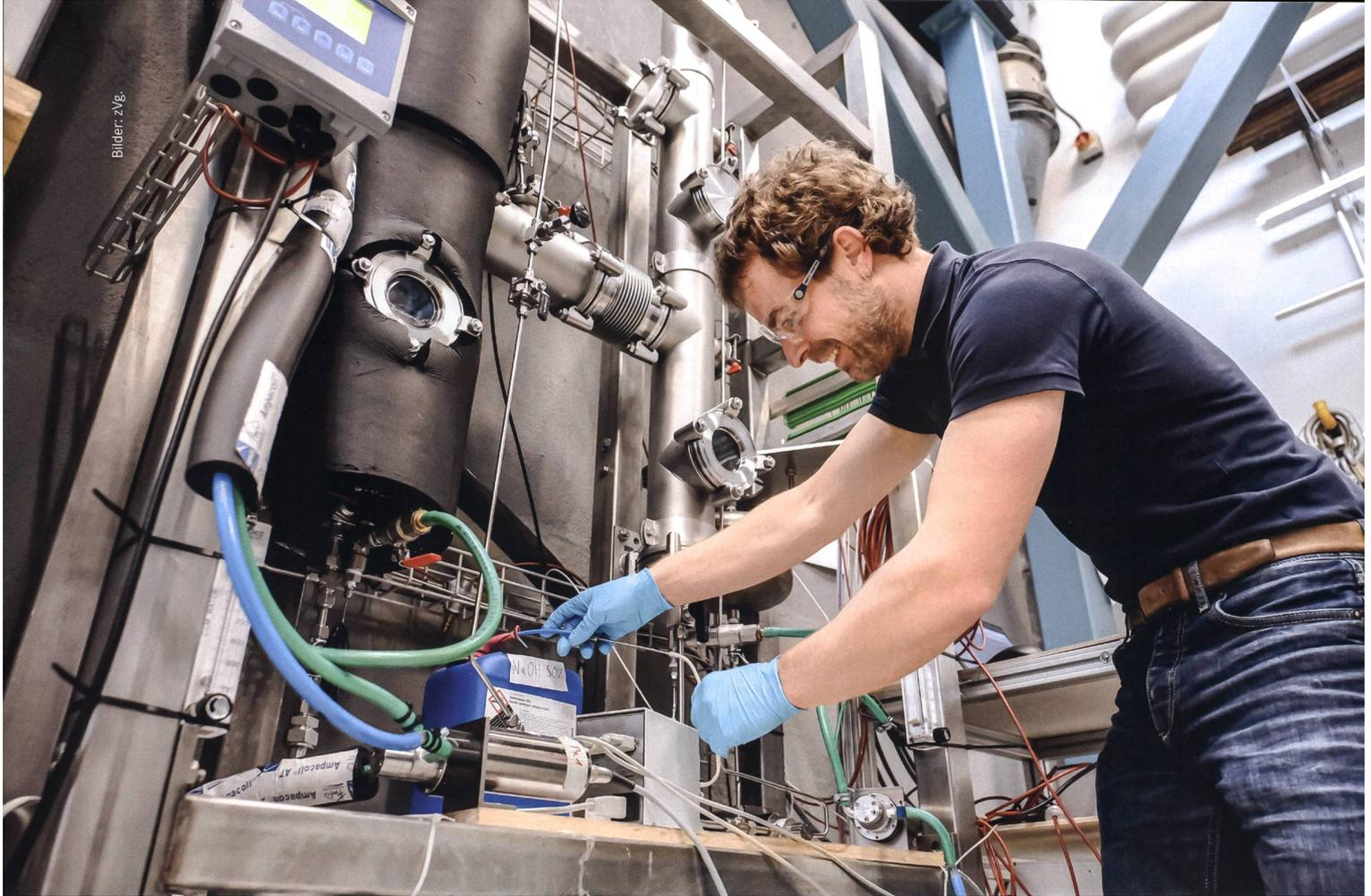
Die Empa hat eine vielversprechende chemische Speicherwärmepumpe entwickelt, die mit Natronlauge funktioniert. Der Lauge wird im Sommer Wärme zugeführt, die sie beim Verdampfen speichert und im Winter durch Zufügen von Wasser wieder abgibt.
