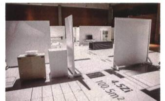
len gleich gut. Das Urner Startup Mister Beam GmbH hat darum in Erstfeld den ersten Grundrissbeamer der Schweiz installiert. In einer ehemaligen Eventhalle können Baupläne im Massstab 1:1 auf den Boden projiziert und Wohnräume mit mobilen Wänden und Möbeln simuliert werden. So werden Bauprojekte räumlich erlebbar und letztlich auch besser planbar.
