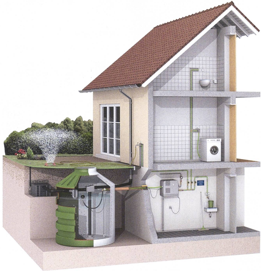
Das Regenwasser wird auf dem Dach gesammelt und in einen unterirdischen Speicher geleitet. Von dort aus führt eine Zuleitung zur Regenwasserzentrale (Hauswasserwerk) im Gebäude, die Toilette, Waschmaschinen und Aussenhahn versorgt (grüne Rohre). Fällt der Wasserstand im Speicher auf ein Minimum, kann Trinkwasser in die Regenwasserzentrale eingespeist werden (graues Rohr).
