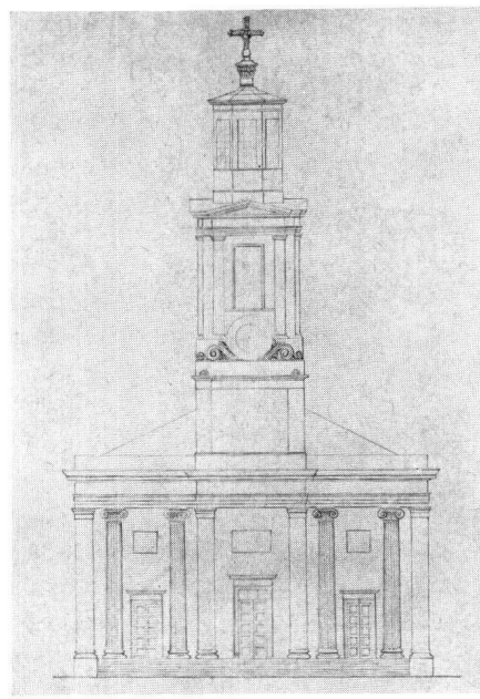
Abb.14 Leonhard Zeugheer: Ausführungsplan für die Neumünsterkirche in Zürich-Riesbach. Aufriß der Hauptfassade mit Frontturm (mit der im Dezember 1836 rückgängig gemachten Korrektur der Baukommission: schlankerer Turmabschluß). Bleistiftzeichnung (wohl Februar 1837) (Baugeschichtliches Archiv der Stadt Zürich, Zeugheer-Nachlaß. Vgl. Abb. 3,4,9)
