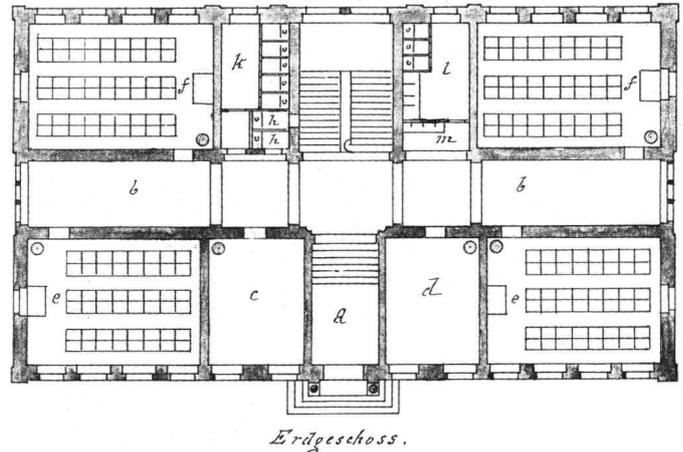
Abb. 8 Grundriss-Skizzen zu einem Schulhaus, von Heinrich Reese, 1883. Erdgeschoss Skizze 1, 1:200 (Plan-Ausschnitt).
