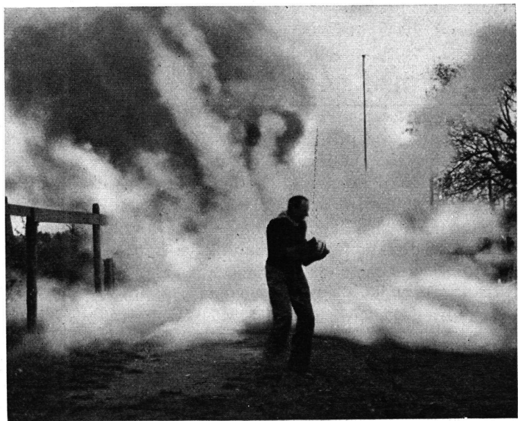
Eine Bombe explodiert auf einem Benzinfeuer, das auf dem Boden ausgebreitet ist. Der Vorführende hat eine Bombe in den Händen. Die erste hatte genügt.
