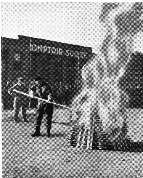
Mit Hilfe einer Stange wirft man die Bombe in die Flammen und in vier Sekunden ist die Glut ausgelöscht. (Öffentlicher Versuch im Comptoir suisse.)
