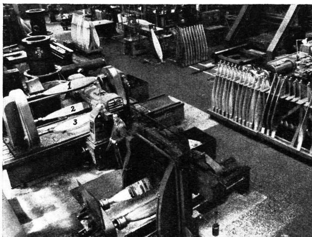
Herstellung modernster Leichtmetallpropeller in einem Werk der schweizerischen Flugzeugzubehörindustrie. Die Maschine in der Bildmitte links ist eine sogenannte Kopierfräsmaschine, die zum Fräsen der Propellerblätter dient. 1 = das sogenannte Abtastmodell aus Holz. Nach diesem Abtastmodell werden gleichzeitig die beiden Leichtmetall-Propellerblattflügel 2 und 3 bearbeitet; d. h. in die gleiche Form gefräst wie Blatt Nr. 1.
