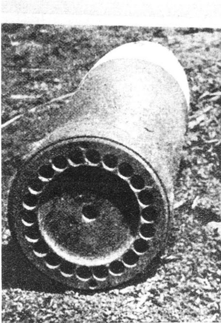
Düsen- und Zündöffnungen eines 21-cm-Raketengeschosses.
