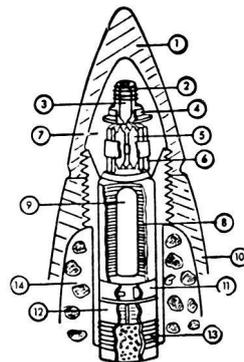
Schematische Darstellung des Radiozünders. 1 Zünderkopf aus nichtleitendem Material; 2 Antenne; 3 Send- und Empfangsröhre; 4 Oszillatorkreis; 5 Drei Verstärkerrohre; 6 Widerstände und Kondensatoren; 7 Wachs-füllung; 8 Batterie; 9 Kapsel mit Elektrolyt-füllung; 10 Geschossmantel; 11 Sicherheitsschalter; 12 Schalter für Selbstexplosion (beim Verfehlen des Zieles in Funktion gesetzt); 13 Initial-Ladung des Zünders; 14 Granaten-Ladung.
