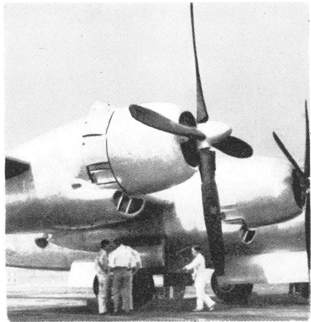
Die Boeing «XB-44», das Zwischenmodell, das aus der «Superfestung» abgeleitet ist und als Versuchsmuster für die neue «B-50» dient.
