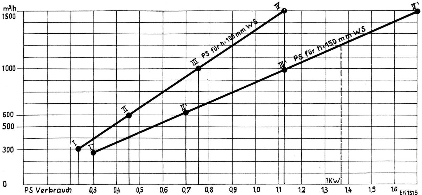
Zur Frostfreiheit von Garagen ist auch bezüglich des Kraftverbrauchs zu berücksichtigen, dass bei den Air-Sana-Anlagen unter normalen Bodenverhältnissen (Sand, bzw. Kiesboden) vom Luftförderaggregat 100 mm WS Widerstand zu überwinden sind, bei Lehm-, bzw. Tonboden, jedoch 150 mm WS.
