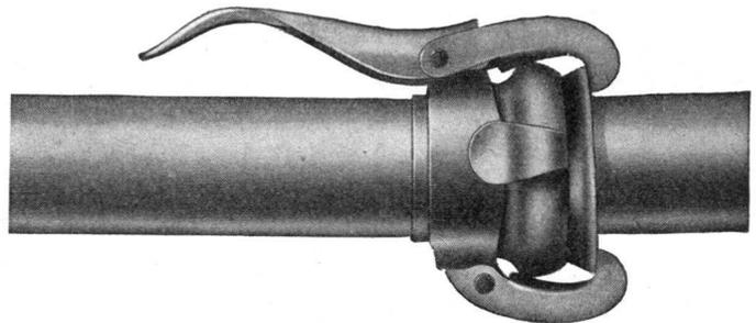
aus Bandstahl, überlappt, geschweisst, absolut dicht, stark abwinkelbar, feuerverzinkt. Durchmesser: 50, 62, 70, 89, 108, 133, 159 mm. Sämtliche Armaturen.
