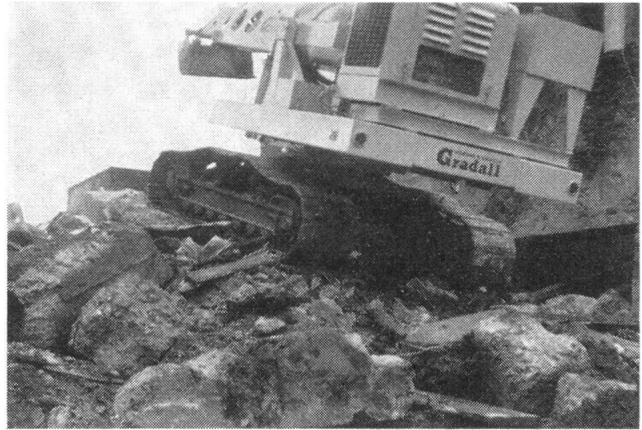
Trümmergängigkeit des Raupenfahrwerks.
