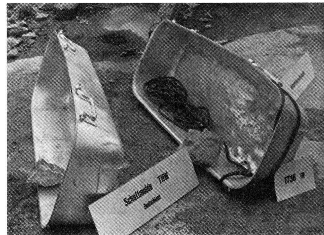
Abb. 16a. Schuttmulde THW zum Fortschaffen von Schutt aus einem Trümmerschlupfweg
