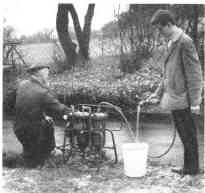
Kompaniewasserfilter nach dem Anschwemmverfahren mit entkeimendem Filtermittel.
