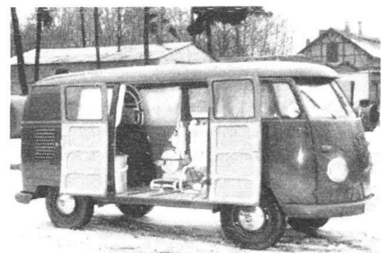
Für den Katastropheneinsatz hat die Industrie besonders schnelle Einheiten geschaffen. Hier ein Gerät mit 4 m 3 Stundenleistung im VW-Bus, gerade aus dem Einsatz Hamburg zurückgekehrt.
