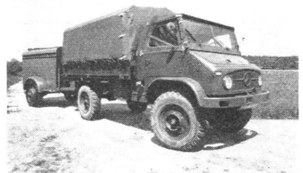
Terratomanlage auf dem Marsch. Auch diese Anlage kann mit Hubschraubern transportiert werden. Dabei wird das im Lastwagen befindliche Gerät im Lastennetz geflogen, in einem zweiten Flug der komplette B-Anhänger.
