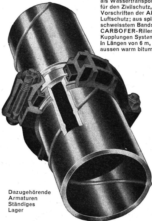
als Wassertransportrohre für den Zivilschutz, gemäss Vorschriften der Abteilung für Luftschutz; aus spiralnahtgeschweisstem Bandstab, mit CARBOFER-Rillenmuffen und Kupplungen System Victaulic, in Längen von 6 m, innen und aussen warm bituminiert.
