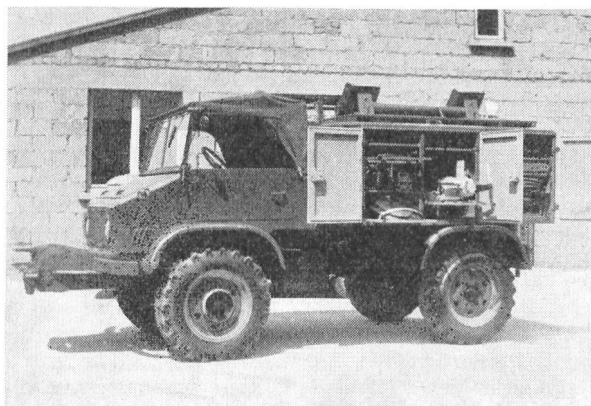
Rettungsdienstwagen mit UNIMOG-S-Fahrgestell
