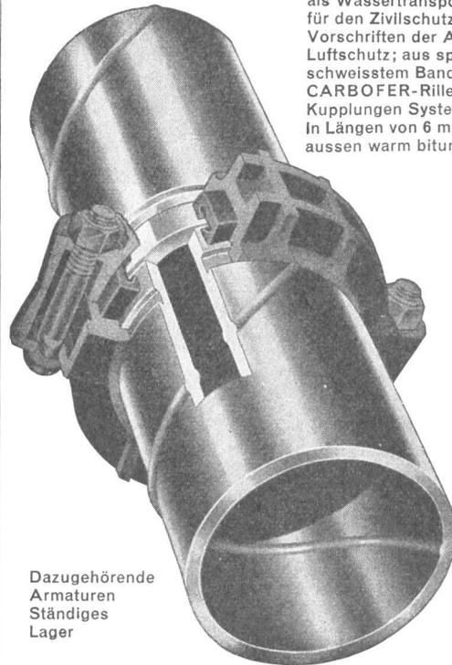
als Wassertransportrohre für den Zivilschutz, gemäss Vorschriften der Abteilung für Luftschutz; aus spiralnahtgeschweisstem Bandstab, mit CARBOFER-Rillenmuffen und Kupplungen System Victaulic, in Längen von 6 m, innen und aussen warm bituminert.
