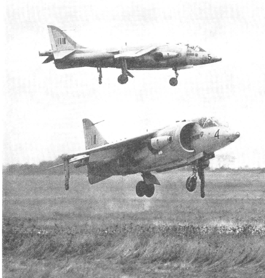
Der erste Senkrechtstarter der Welt, Hawker P 1127 «Kestrel», wird in einer gemischten englisch-deutsch-amerikanischen Versuchsstaffel erprobt. Die vordere Maschine im Schwebeflug kurz vor der Landung. Werksphoto Hawker Siddeley
