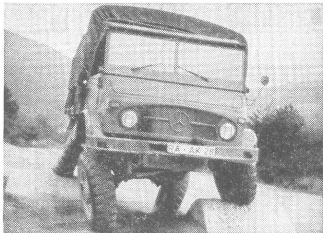
Die hohe Verwindungsfähigkeit des Unimog-S-Chassis, verbunden mit dem echten Allradantrieb auf vier gleich grosse Räder und dazu Differentialsperre in Vorder- und Hinterachse, verleiht diesem Fahrzeug eine hervorragende Geländegängigkeit.
