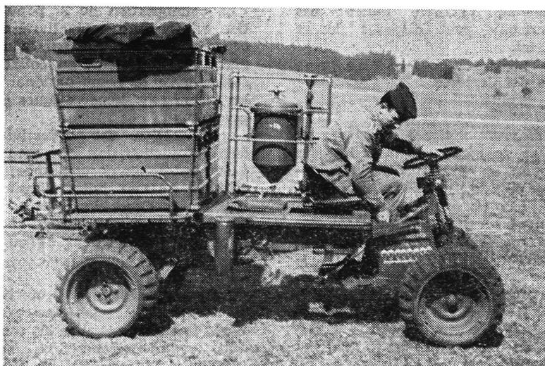
BERKEFELD -Trinkwasseraufbereiter AQUA-SERVER, 2 m<sup>3</sup>/h, aufmontiert auf kraka, konnte bei dem Fallschirmabwurf in Altenstadt am 28./29. März 1968 unmittelbar nach der Landung in voller Funktion eingesetzt werden
