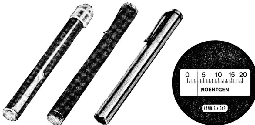
Skala im Dosimeter mit einem Messbereich von 0—20 Roentgen
