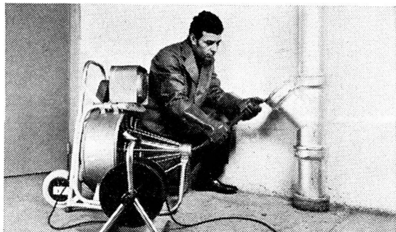
Entstopfer Typ A20 für Rohre von 50–300 mm \varnothing und bis zu 30 m Länge. Für Rohre über 300 mm \varnothing lohnt sich der Einsatz unserer «Atümat»-Hochdruckreinigungsgeräte.
