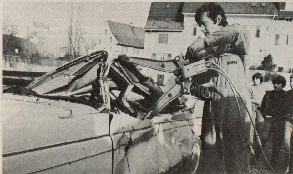
Die Rettungsschere im Uebungseinsatz
