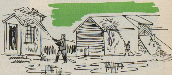
Nedfall kan fjernes ved spyling.
