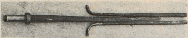
Abb. 23. Spaltbacken und Spaltkeil
