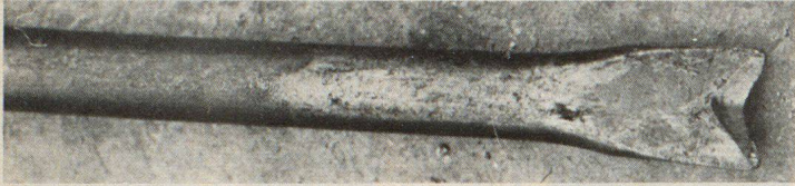
Abb. 24. V-förmige Schneide des Schneideisens
