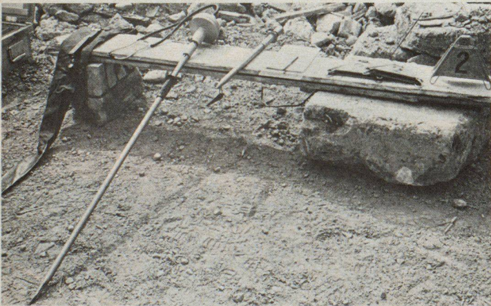
Abb. 6. Ortungsausrüstung des dänischen Zivilschutzes
