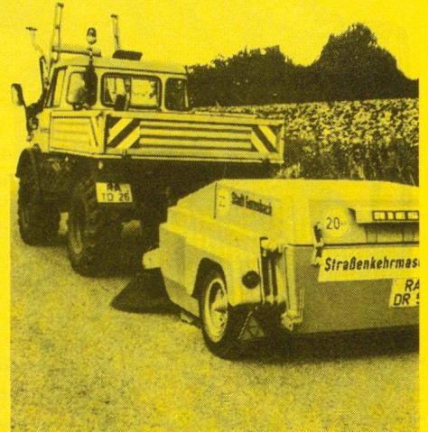
Die Anhängkehrmaschine. Kehrt mit 5-7 km/h. (Kehrbreite: 2,30 m) Danach ist der Unimog für andere Arbeiten frei.
