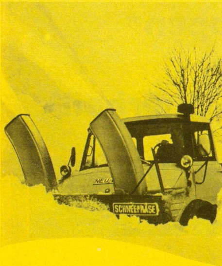
Die Unimog-Zapfwellenschneefräse schafft bis zu 2500 m 3 /h. Durch die Schnellwechseleinrichtung ist sie in Minuten gegen eines der nebenstehenden Geräte ausgetauscht.
