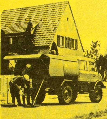
Unimog-Hochdruck-Kanalspüleinrichtung 1000-1200 m Tagesleistung.
