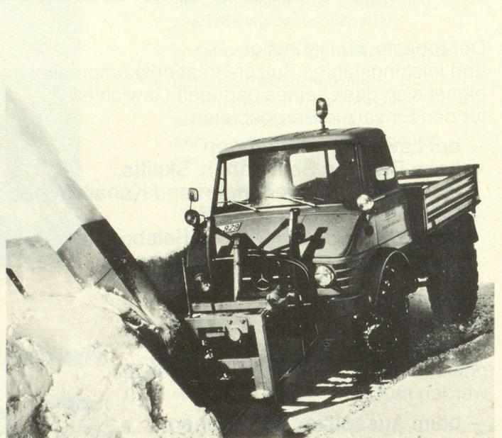
Der Unimog mit Seitenschneesleuder räumt bis zu 3 000 m<sup>3</sup>/h Randwälle.
