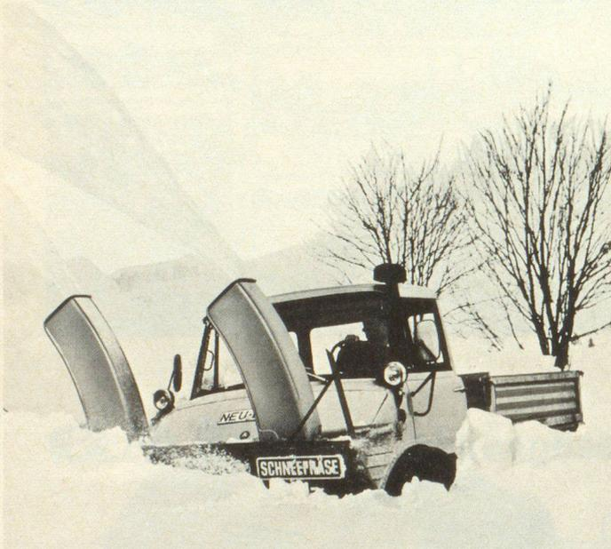
Die Unimog-Zapfwellen-Schneefräse schafft bis zu 2 500 m<sup>3</sup>/h. Durch die Schnellwechseleinrichtung ist sie in Minuten gegen eines der nebenstehenden Geräte ausgetauscht.
