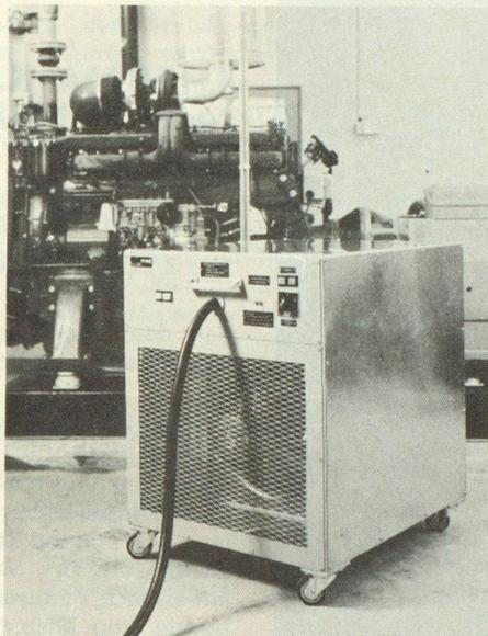
rators entspricht. Aufgrund jahrelanger Erfahrung in Anlagen der PTT, der Gruppe für Rüstungsdienst, Abteilung für Genie- und Festungswesen, sowie für den Zivilschutz entwickelte die Firma Normel GmbH in Bern spezielle Belastungswiderstände für Zivilschutzanlagen. Diese Widerstände sind fahrbar und können zum Beispiel mit einem VW-Kastenwagen transportiert werden. Je nach Leistung ändert das Gewicht, doch genügen für den Verlad 2 Mann. Die Widerstände weisen im übrigen folgende Merkmale auf:
