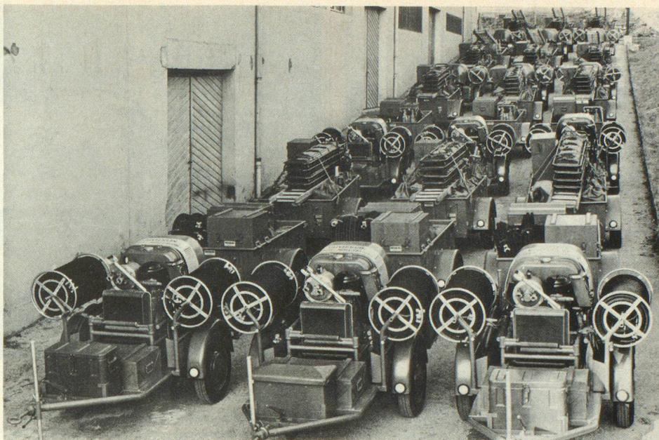
Vis-à-vis de nous a été déposé le matériel que l'on utilise pour sauver des gens. On voit également des machines sur roues à pneus; ce sont des compresseurs qui produisent de l'air sous pression servant à faire fonctionner des outils pneumatiques. Ces outils permettent aux sauveteurs de la protection civile de se frayer un passage dans les endroits pleins de décombres.
