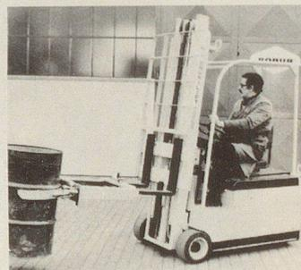
Neuer mechanischer Fassgreifer für schnelles und sicheres Verladen, Transportieren und Stapeln von Rollreifentässern (FTA Fahrzeugtechnik AG, CH-5035 Unterentfelden)
