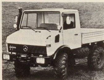
Das neue **Unimog-Getriebe** besteht aus einem Achtgang-Grundgetriebe, das mit einer nachgeschalteten Planetengruppe um acht Arbeitsgänge erweitert ist und das auf Wunsch mit weiteren acht Kriechgängen ausgerüstet werden kann. Demnach stehen mindestens 16, auf Wunsch 24 Gänge zur Verfügung. Der Geschwindigkeitsbereich umfasst bei der Serienbereifung 14,5-20 (10 PR) 0,13 bis 73 km/h. Wahlweise stehen zwei weitere
