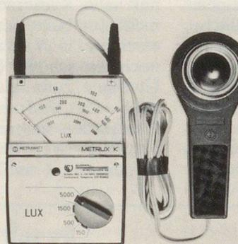
freibeweglichen Kelle – wandelt die auftreffende Lichtenergie in einen Strom um, der vom Instrument angezeigt wird. Das Fotoelement ist der Augenempfindlichkeit so weitgehend angepasst, dass der Beleuchtungsmesser bei den meisten heute verwendeten Lichtquellen – Glühlampen und Leuchtstofflampen – ohne Korrektur zu benutzen ist.
