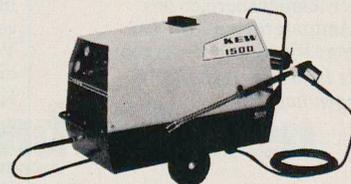
**Kalt- und Heisswasser-Hochdruckreiniger
