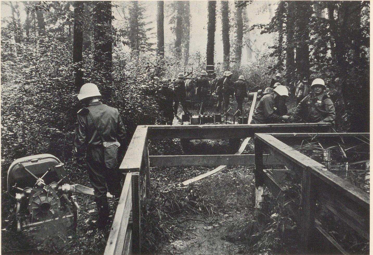
Aufbau des Wassertransportes ab Wasserbezugsort Emmenkanal zum Ausgleichbecken am Rand der Schadenzone.
