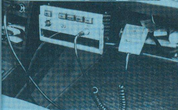
Mobile Sirenanlage für den schnellen, mobilen Einsatz. Vollelektronisch und mit Sprachdurchsage. Das Steuergerät hat im Handschuhfach platz, der Dachständer mit Lautsprecher und Drehleuchte ist blitzschnell montiert.
