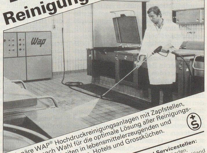
Stationäre WAP® Hochdruckreinigungsanlagen mit Zapfstellen, Anschlüssen nach Wahl für die optimale Lösung aller Reinigungs- und Desinfektionsarbeiten in lebensmittelerzeugenden und -verarbeitenden Unternehmen, Hotels und Grossküchen.
