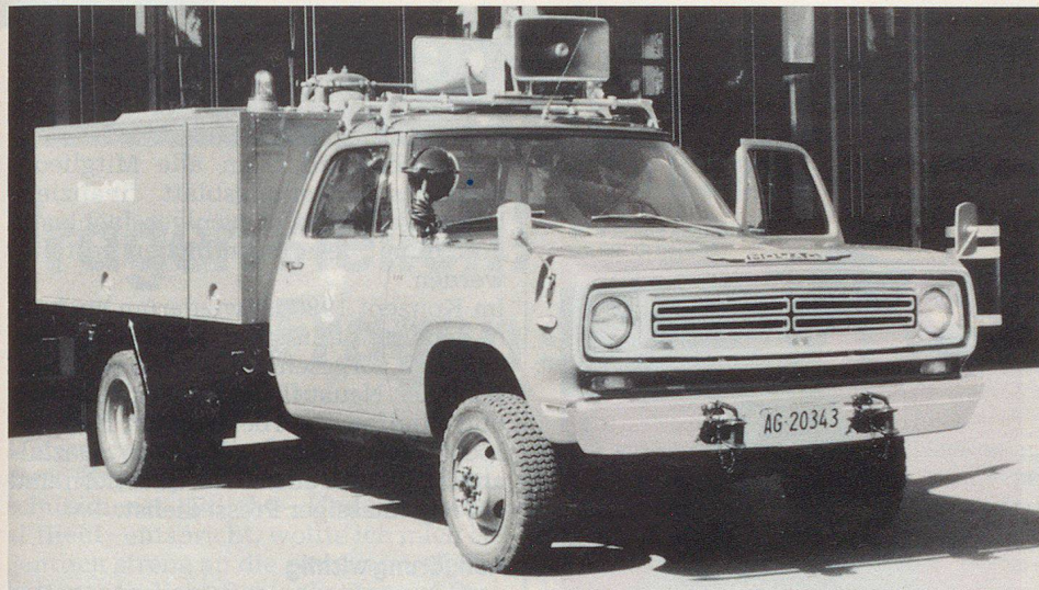
Feuerwehrfahrzeug mit montierter mobiler Sirene.
