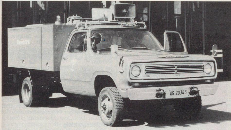
Feuerwehrfahrzeug mit montierter mobiler Sirene.
