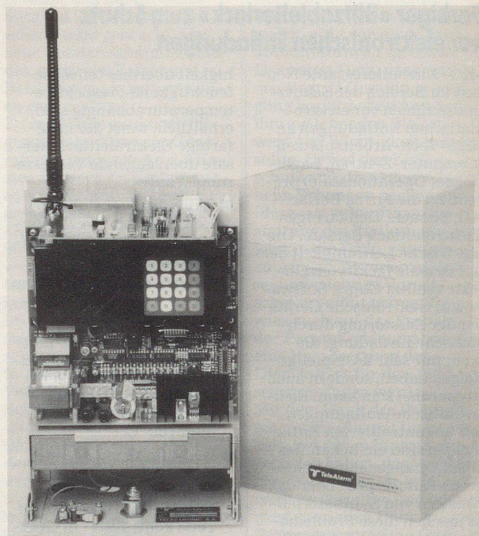
Tele-Alarm-Multi 12/22 – ein zuverlässiger Alarmübermittler und folgsamer Befehlsempfänger.
