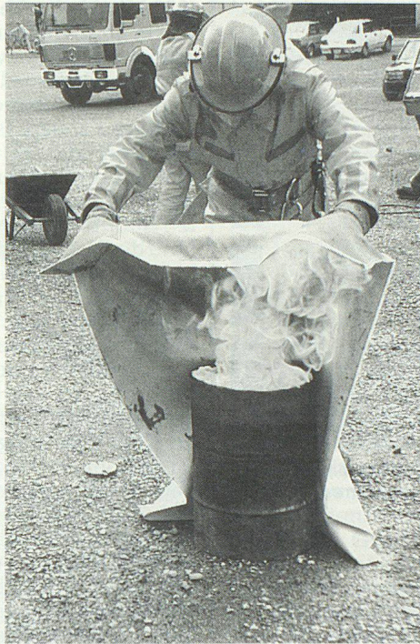
Einsatz mit einer geprüften und zugelassenen gasdichten Löschedecke.
