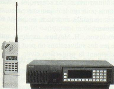
Moderne Hand- und Fahrzeugfunkgeräte, Fixstationen und Vermittlungseinrichtungen von Ascom sind für Bündelfunk ausgelegt und anwenderspezifisch programmierbar.
