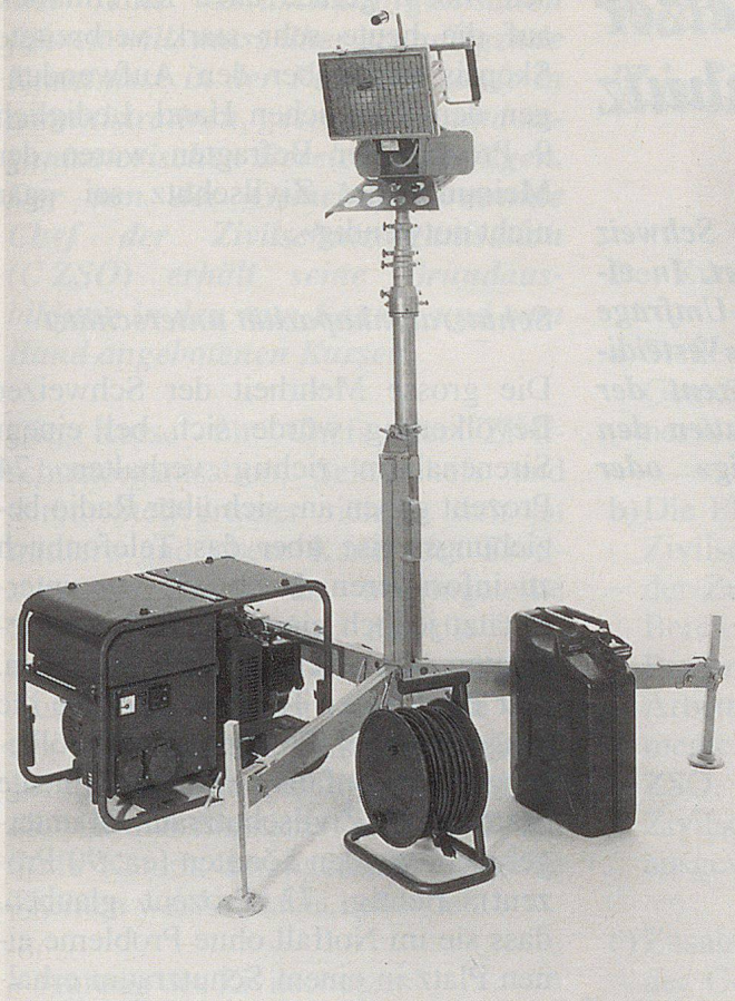
Beleuchtungs-ausrüstung (Notstromaggregat, Scheinwerfer, Zubehör).
