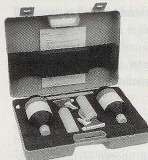
Die Dichtigkeitsprüfung mit dem ICB-Prüfset ist harmlos und empfindlich, auch geringe Undichtigkeiten werden zuverlässig aufgezeigt.
