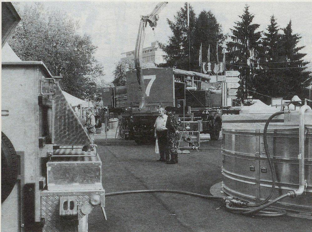
A destra la vasca da 50 m<sup>3</sup> del Welab 8 (protezione dell'ambiente) nella quale viene raccolta acqua sporca - ad esempio in caso di incidenti con fuoriuscita di olio - e quindi depurata.
