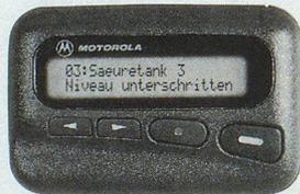
Alarmierung mit AUTOPAGE® auf Motorola-Pager Scriptor LX2 mit Ladegerät via TELEPAGE® swiss.
