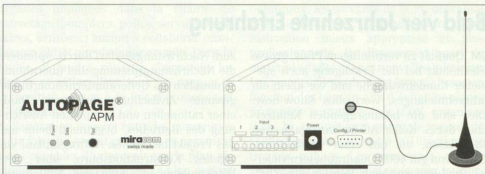
bis vier Alarmkontakte oder Gleichspannungssignale von 5 bis 24 V und übermittelt die Alarme dem Verantwortlichen im Klartext auf einen alphanumerischen Pager, ein Natel D/SMS, auf einen Telefax oder eine Alarmzentrale. Das Modulgehäuse erlaubt den direkten Einbau in Schalttafeln oder in 19"-Systemtechnik. Alle Anschlüsse (Eingänge, Netz- und Telefonanschlüsse) sind steckbar ausgeführt. Die Konfiguration der vier individuellen Eingänge enthält nebst der Alarmmeldung
